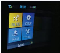
**D**isplay de 2" de alta claridad; con dos teclas función y tecla de navegación tipo joystick
